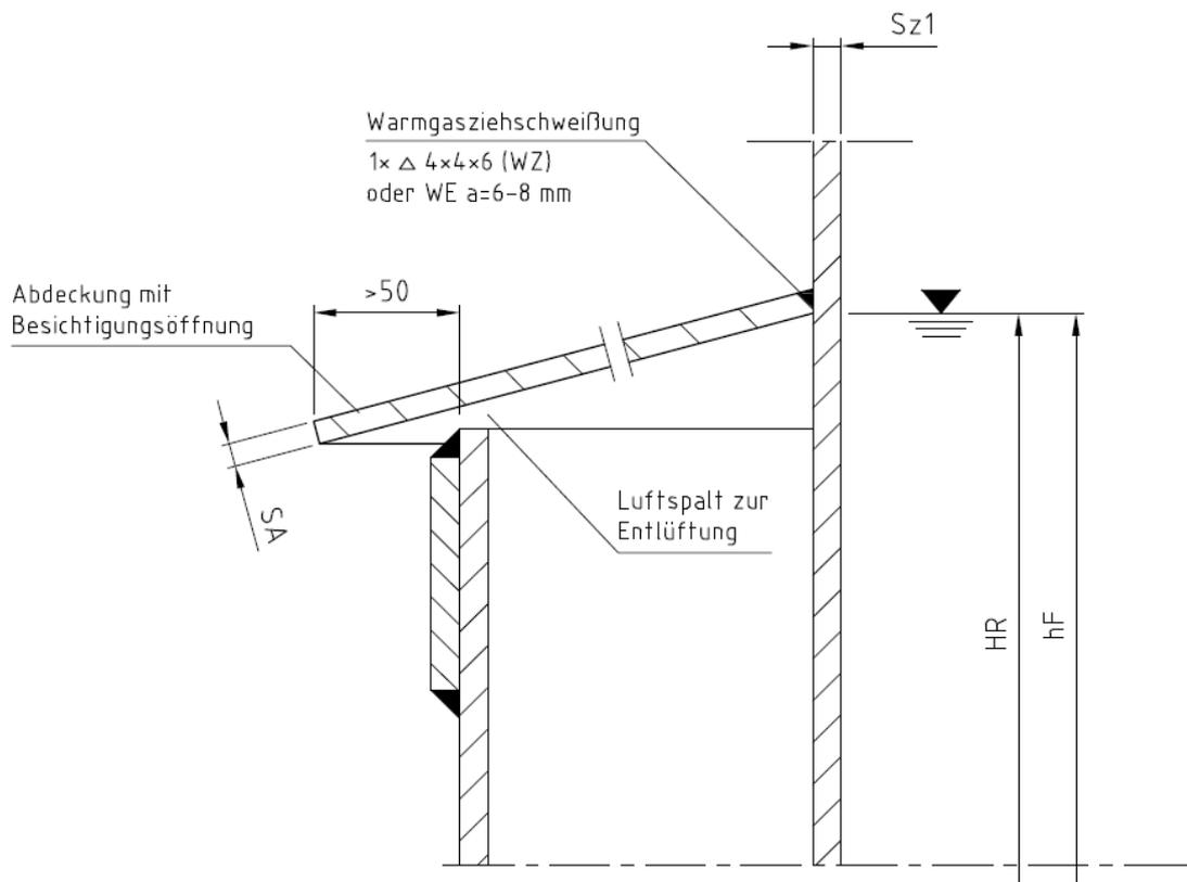
Befestigung des Regenabweisers in Abhängigkeit von hF:
