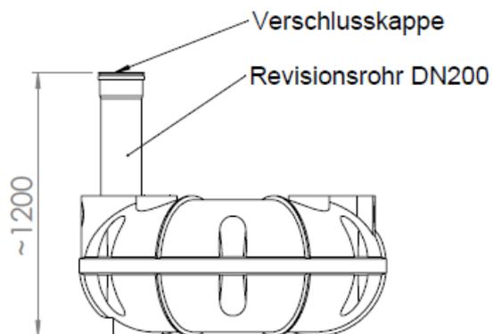
Begehbare Version mit Revisionsrohr DN200 und Verschlusskappe
