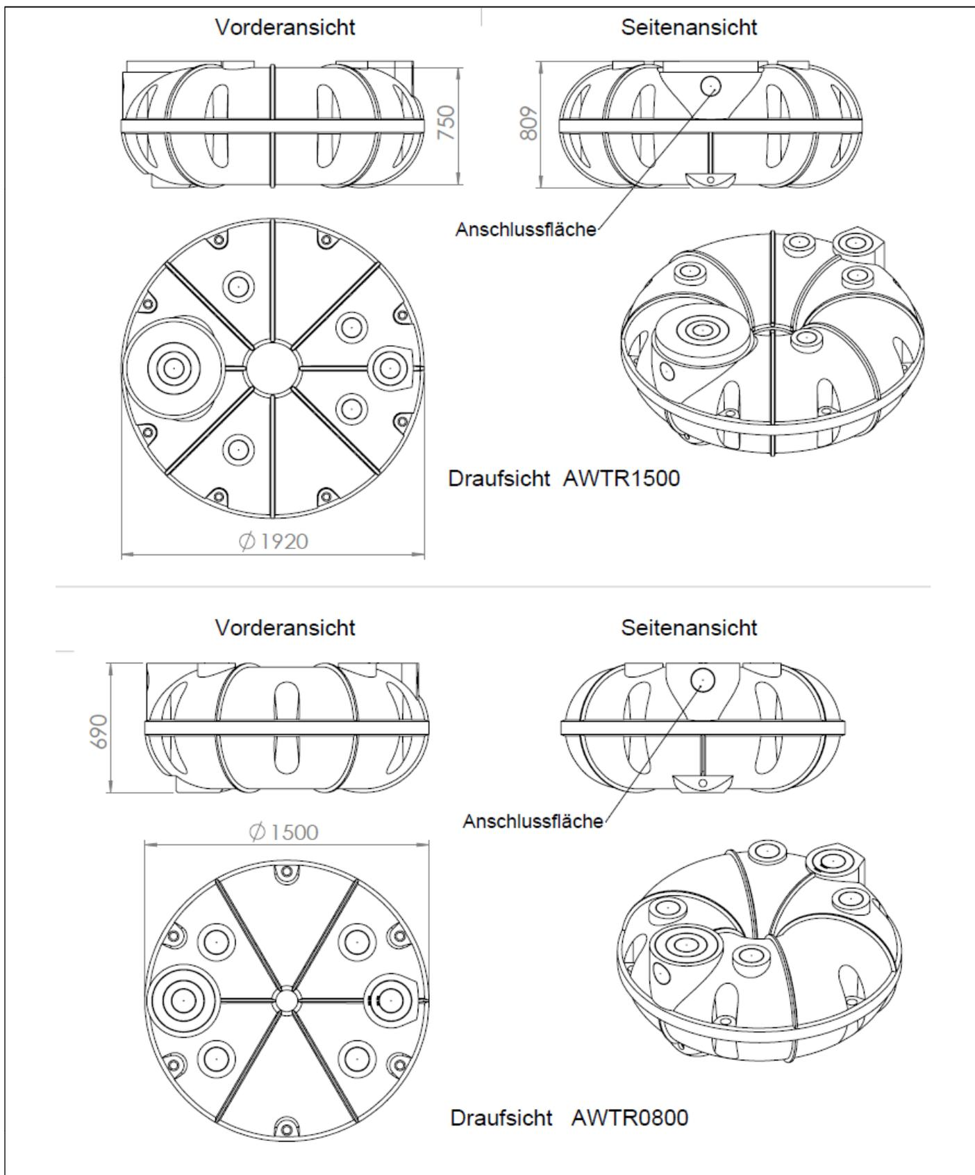
Abflusslose Sammelgrube aus rotationsgeformten Polyethylen PE-LLD für die Lagerung von häuslichem Abwasser Typ: Torus 800 und 1500
