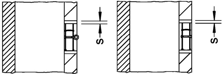
Schachtwanddicke ohne innenliegende Stahlblechleitung **mind. 60 mm**
