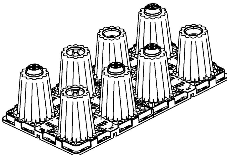
Modulares Rigolensystem für die Versickerung von Niederschlagswasser mit der Bezeichnung "ACO Stormbrixx"
