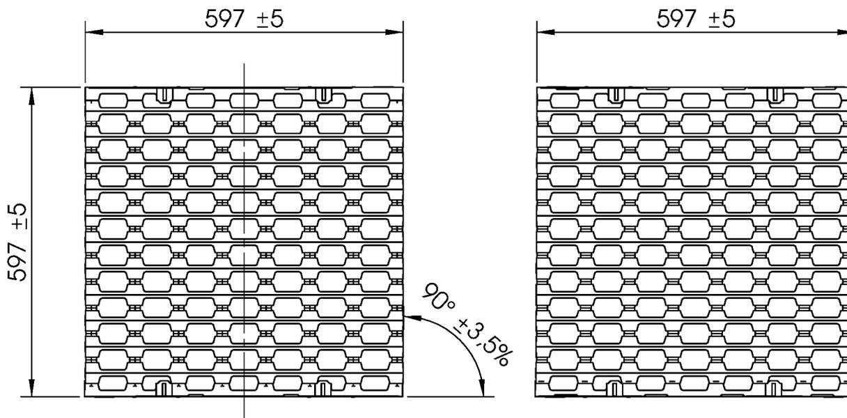
Versickerungsblöcke für die Versickerung von Niederschlagswasser mit der Bezeichnung
