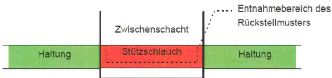
Schlauchlinierverfahren mit der Bezeichnung „INPIPE Liner“ zur Sanierung von erdverlegten schadhafte Abwasserleitungen
