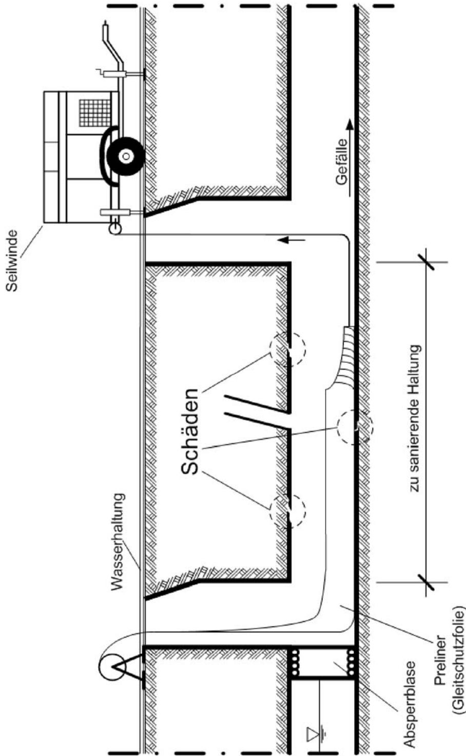
Der Einzug eines Preliners (Gleitschutzfolie) ist obligatorisch. Abgestimmt auf die jeweilige Baustellensituation, entscheidet der Bauleiter vor Ort, welcher Preliner (Flach- oder Schlauchfolie) zum Einsatz kommt.
