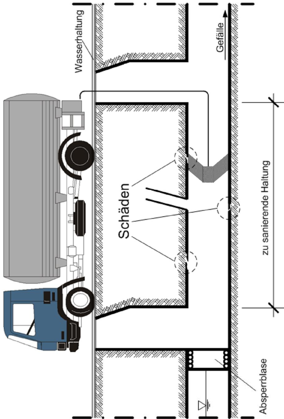
Die Hochdruckspülung zur Reinigung der Haltung sollte, soweit möglich, immer vom Tiefpunkt zum Hochpunkt durchgeführt werden, um mit dem Spülwasserablauf das Reinigungsergebnis abschätzen zu können.
