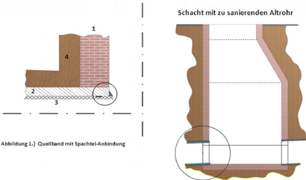
Abbildung 1.) Quellband mit Spachtel-Anbindung
