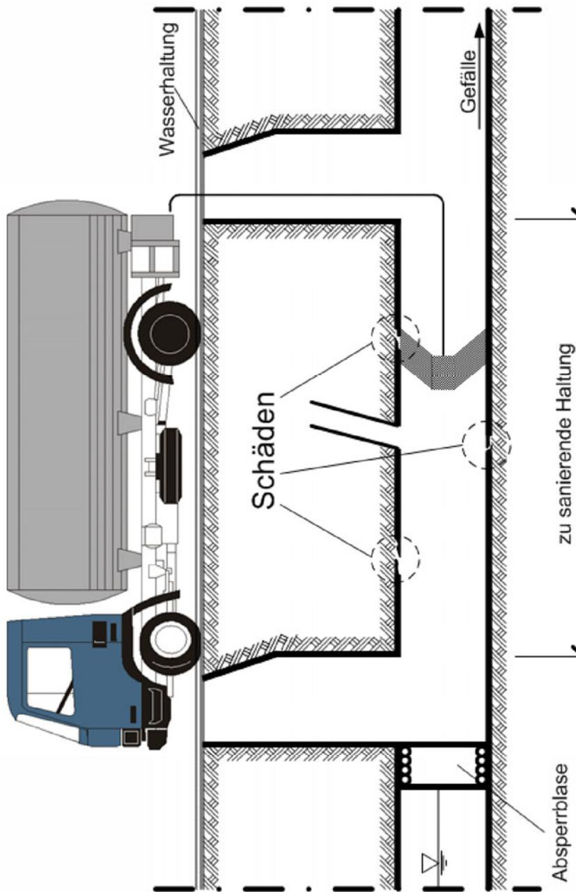
Die Hochdruckspülung zur Reinigung der Haltung sollte, soweit möglich, immer vom Tiefpunkt zum Hochpunkt durchgeführt werden, um mit dem Spülwasserablauf das Reinigungsergebnis abschätzen zu können.
