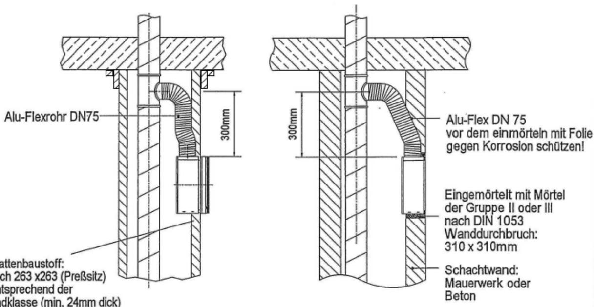
Einbau außerhalb von Lüftungsschächten mit 300mm Höhenversatz!
