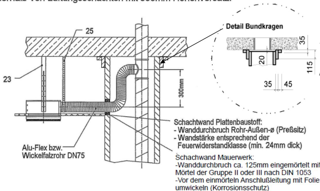
Einzelentlüftungsgeräte zur Verwendung in Einzelentlüftungsanlagen mit gemeinsamer Abluftleitung gemäß DIN 18017-3 (08/1990) Typen Vario U/V-60, UK/V-60, UB/V-60,
