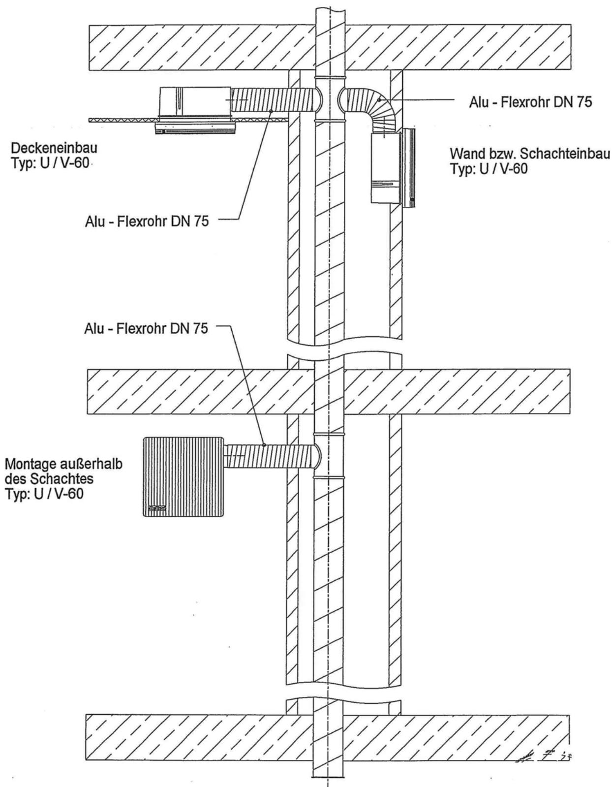
Einzelentlüftungsgeräte zur Verwendung in Einzelentlüftungsanlagen mit gemeinsamer Abluftleitung gemäß DIN 18017-3 (08/1990) Typen Vario U/V-60, UK/V-60, UB/V-60,
