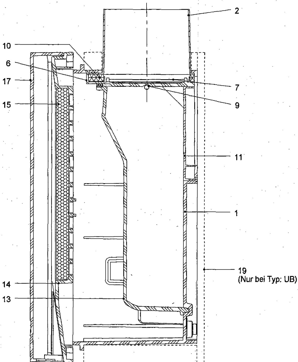
Einzelentlüftungsgeräte zur Verwendung in Einzelentlüftungsanlagen mit gemeinsamer Abluftleitung gemäß DIN 18017-3 (08/1990) Typen Vario U/V-60, UK/V-60, UB/V-60,
