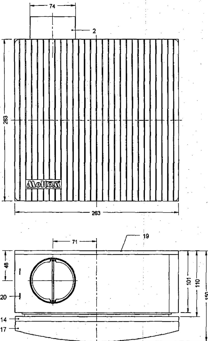
Einzelentlüftungsgeräte zur Verwendung in Einzelentlüftungsanlagen mit gemeinsamer Abluftleitung gemäß DIN 18017-3 (08/1990) Typen Vario U/V-60, UK/V-60, UB/V-60,
