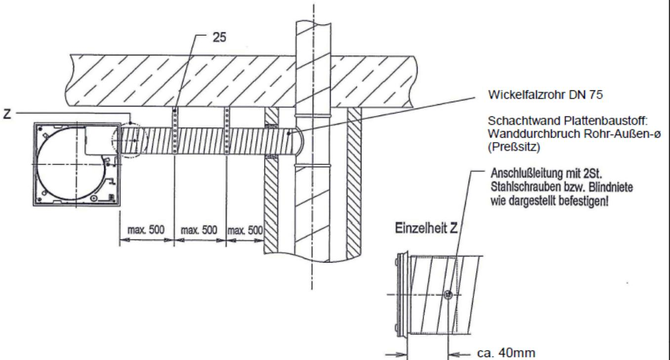
Einzelentlüftungsgeräte zur Verwendung in Einzelentlüftungsanlagen mit gemeinsamer
