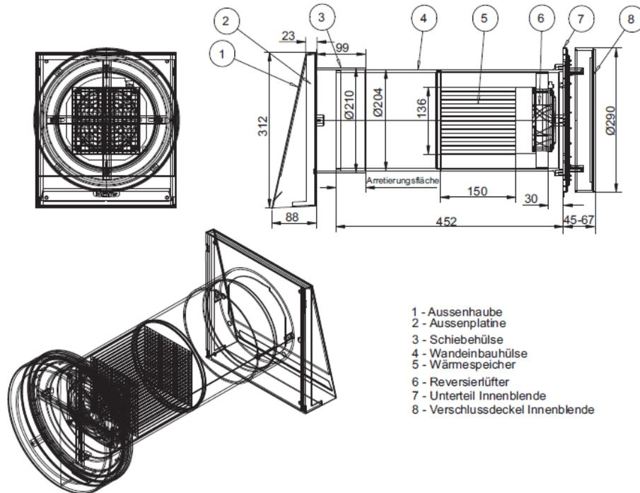
Dezentrales Lüftungssystem mit Wärmerückgewinnung inVENTer iV14 unter Verwendung von Lüftungsgeräten der Typen "iV14V" oder "iV14R"
