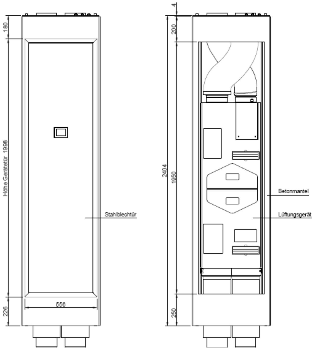
Das Lüftungsgerät "AERA Eqonic" wird im "AERA Eqonic Modulkörper", bestehend aus einem Betonmantel und einer Stahltür, installiert.
