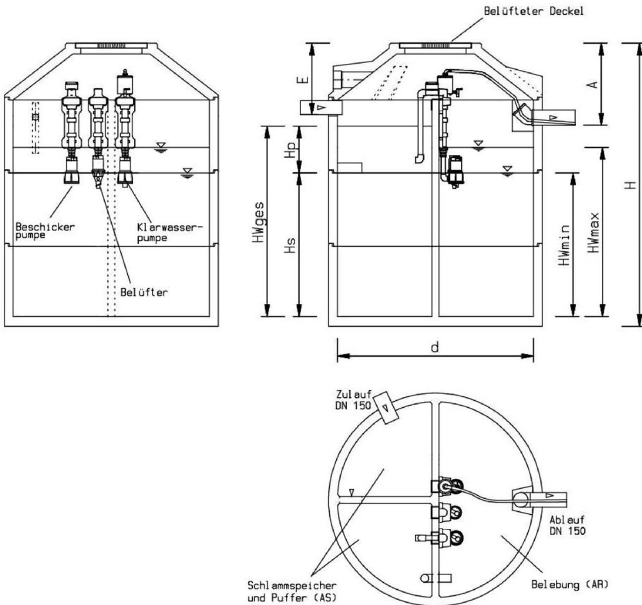
Anwendungsbestimmungen für Kleinkläranlagen nach DIN EN 12566-3 mit CE-Kennzeichnung: Belebungsanlagen im Aufstaubetrieb Typ LKT-BIO aus Beton, Ablaufklasse D
