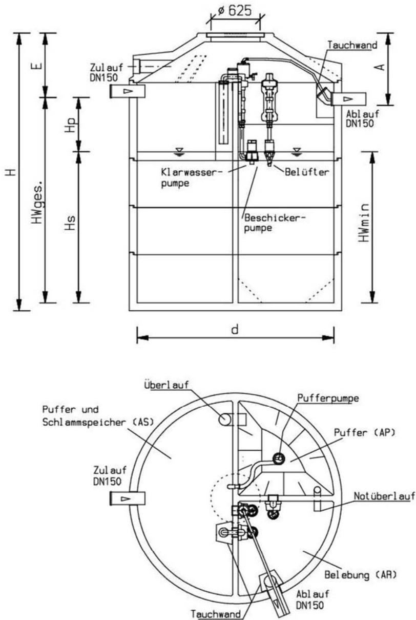
Anwendungsbestimmungen für Kleinkläranlagen nach DIN EN 12566-3 mit CE-Kennzeichnung: Belebungsanlagen im Aufstaubetrieb Typ LKT-BIO aus Beton, Ablaufklasse D
