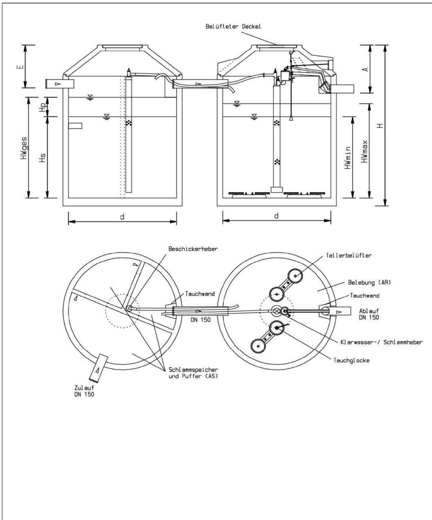
Anwendungsbestimmungen für Kleinkläranlagen nach DIN EN 12566-3 mit CE-Kennzeichnung: Belebungsanlagen im Aufstaubetrieb Typ LKT-BIO aus Beton, Ablaufklasse D
