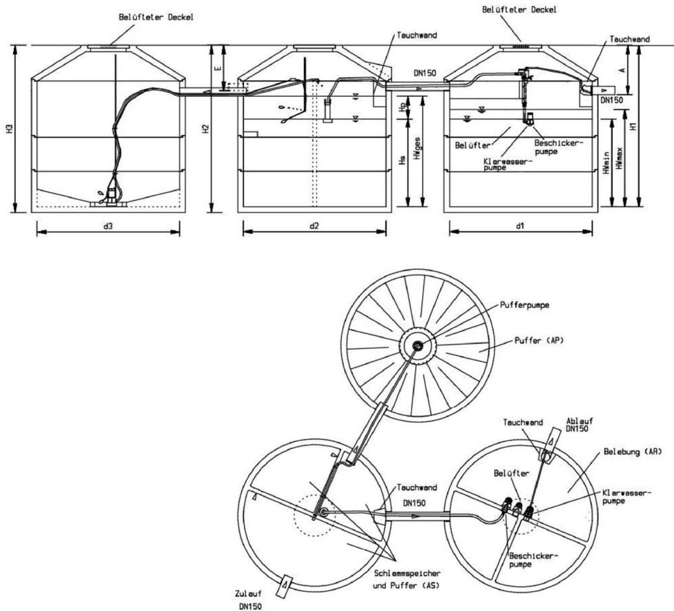
Anwendungsbestimmungen für Kleinkläranlagen nach DIN EN 12566-3 mit CE-Kennzeichnung: Belebungsanlagen im Aufstaubetrieb Typ LKT-BIO aus Beton, Ablaufklasse D
