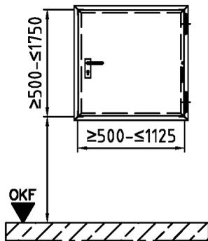
4-seitige Konstruktion für nicht fußbodengleichen Einbau (d.h. bei sog. Verwendung in größerer Höhe)
