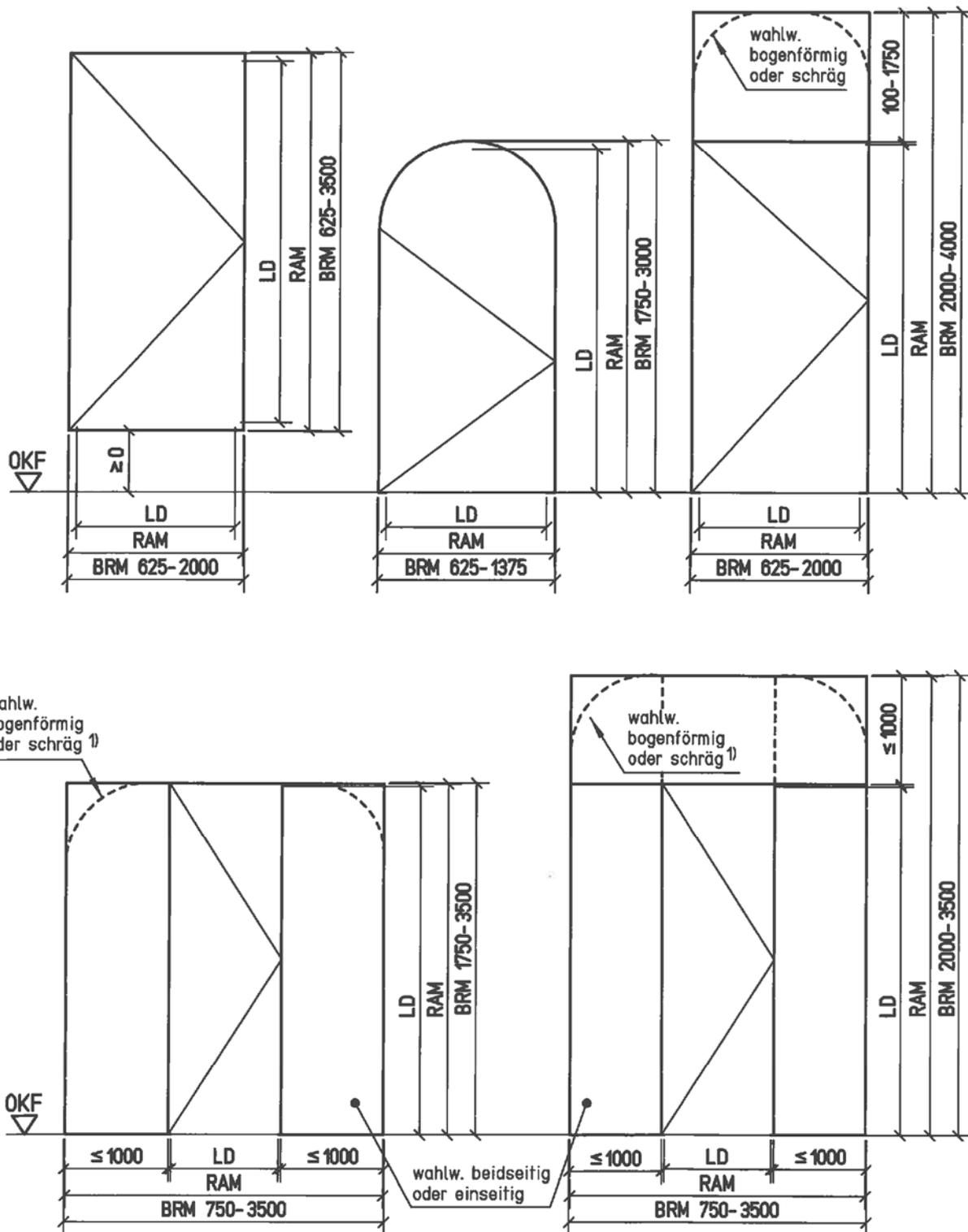
T 30-1-FSA "Form-Brandschutztür Typ 16N" bzw. T 30-1-RS-FSA "Form-Brandschutztür Typ 16N"
