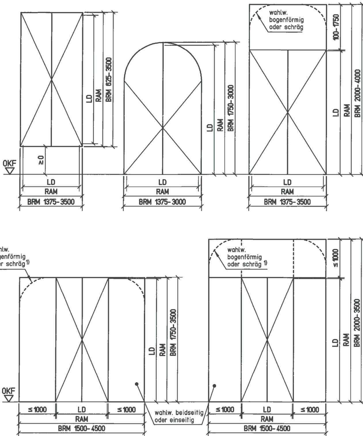
T 30-1-FSA "Form-Brandschutztür Typ 16N" bzw. T 30-1-RS-FSA "Form-Brandschutztür Typ 16N"
