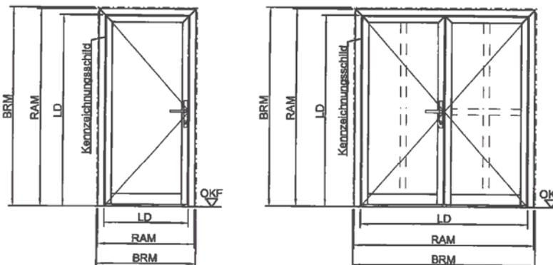
T30-1-RS-FSA Tür und T30-2-RS-FSA Tür immer mit absenkbarer Bodendichtung ausführen
