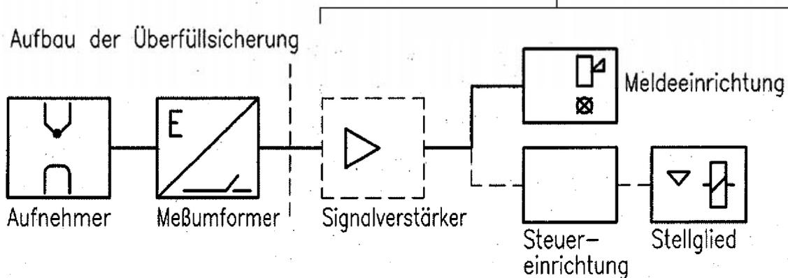
Standaufnehmer (Wärmeableitung) Typ UNS 2500-.. und Messumformer als Standgrenzschalter von Überfüllsicherungen
