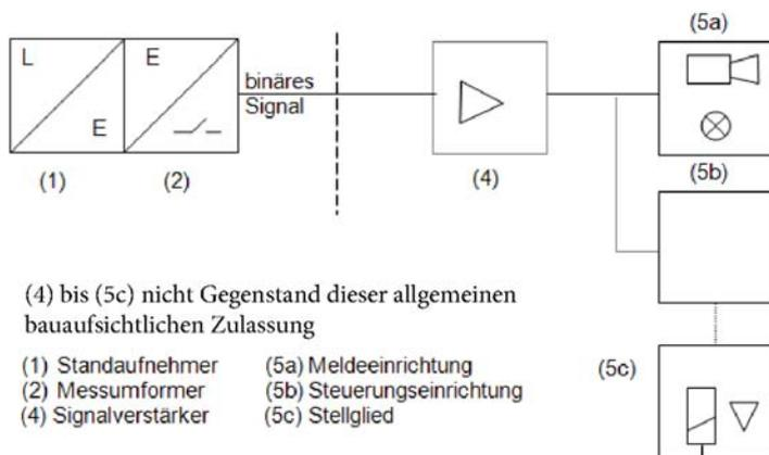
Standaufnehmer (Schwingsonde) mit integriertem Messumformer als Teil von Überfüllsicherungen, Bezeichnung: "Rosemount 2130"
