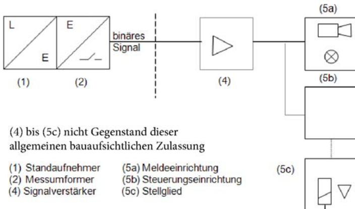
Standaufnehmer (Schwingsonde) mit integriertem Messumformer als Teil von Überfüllsicherungen, Bezeichnung: "Rosemount 2130"
