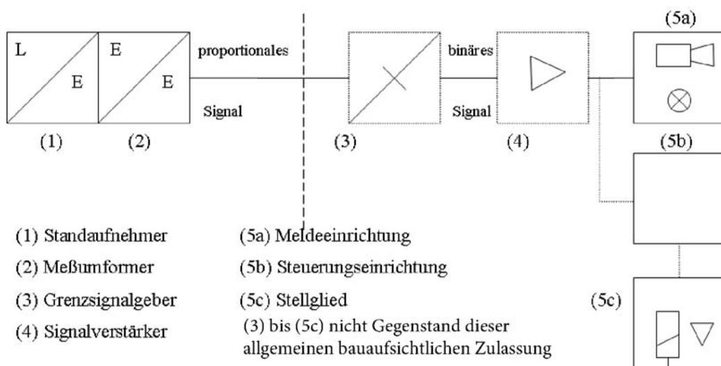
Standaufnehmer (Radar-Antennen) "Rosemount 5300" mit angebautem Messumformer als Teil von Überfüllsicherungen
