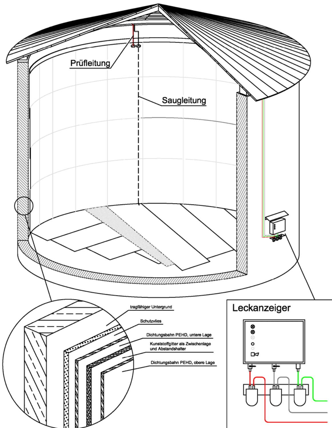
Leckschutzauskleidung Typ "RA-Protect" als Teil eines Leckanzeigegerätes für Beton- und Stahlbehälter zur Lagerung von verschiedenen Flüssigdüngern und NOx-Reduktionsmittel
