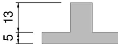
EPDM-Füllstück, L = 25 mm
