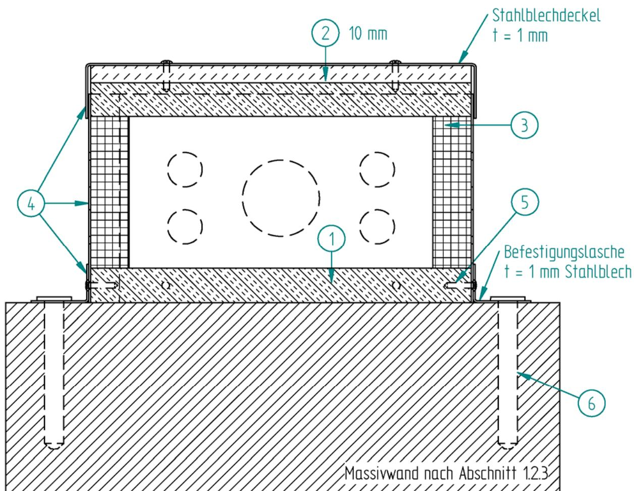
Brandschutzgehäuse mit einer Feuerwiderstandsdauer von mindestens 30 Minuten bei einer Brandbeanspruchung von außen
