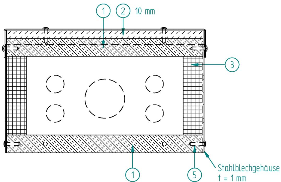
Brandschutzgehäuse mit einer Feuerwiderstandsdauer von mindestens 30 Minuten bei einer Brandbeanspruchung von außen
