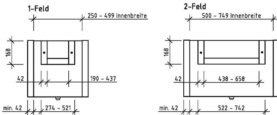
Brandschutzgehäuse mit einer Feuerwiderstandsdauer von mindestens 30 Minuten bei einer Brandbeanspruchung von innen
