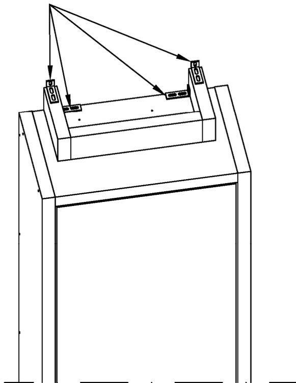
Winkelbefestigung für EABK bei Montage unter dem PRIOELEC-Gehäuse
