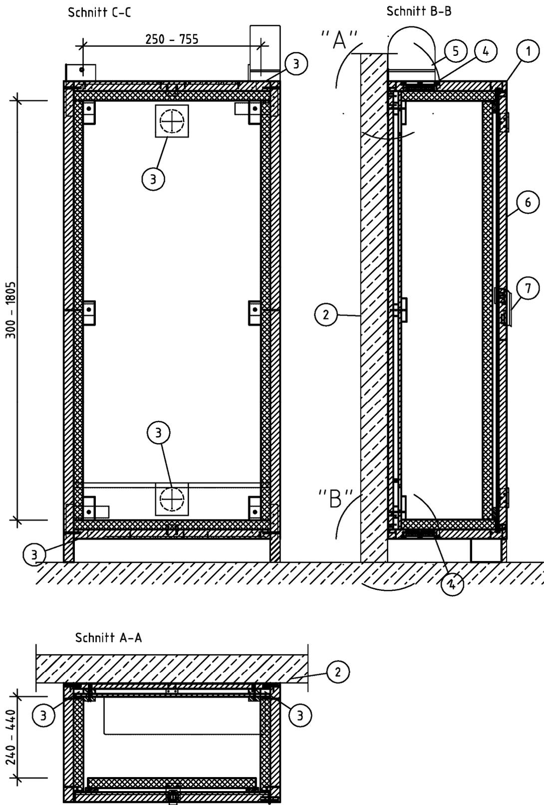
Brandschutzgehäuse mit einer Feuerwiderstandsdauer von mindestens 30 Minuten bei einer Brandbeanspruchung von innen
