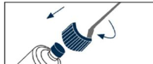
Zugehörige Statikmischer und Auspressgeräte verwenden. Verschlusskappe abschrauben, Statikmischer aufschrauben und Kartusche in das Auspressgerät einführen.
