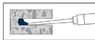
Mörtelinjektion vom Bohrlochgrund beginnend; Lufteinschlüsse vermeiden und den Statikmischer während des Auspressens langsam herausziehen. Bohrloch etwa zu 2/3 der Bohrl Lochtiefe mit Injektionsmörtel füllen.
