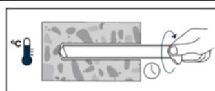
Unmittelbar nach der Injektion Stahlteil bis zur Markierung der Verankerungstiefe durch leichtes Drehen einführen. Das Bohrloch muss dabei vollständig mit Mörtel gefüllt werden. Mörtelüberschuss entfernen.
