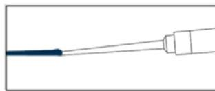
Vor der Injektion bei jeder neuen Kartusche die ersten Hübe verwerfen bis eine einheitliche Farbe des Mörtels austritt. Bei  $h_{ef} > 240$  mm Verlängerungsschläuche und Stauzapfen verwenden.
