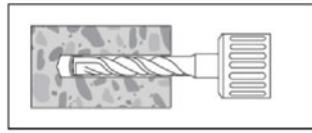
Bohrlochherstellung unter Beachtung der korrekten Bohrdurchmesser und Bohrlochtiefe nur durch Hammerbohren senkrecht zur Betonoberfläche.
