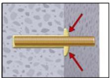
8. Nach der Installation des Ankers sollte der Ringspalt komplett mit Mörtel ausgefüllt sein. Tritt keine Masse nach Erreichen der Verankerungstiefe heraus, ist diese Voraussetzung nicht erfüllt und die Anwendung muss vor Beendigung der Verarbeitungszeit wiederholt werden. Bei Überkopfmontage ist die Ankerstange zu fixieren (z.B. Holzkeile).
