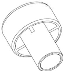
**Verfüllstutzen für Überkopf- oder Horizontalmontage**
