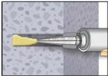
6. Gereinigtes Bohrloch vom Bohrlochgrund her ca. zu 2/3 mit Verbundmörtel befüllen. Langsames Zurückziehen des Statikmischers aus dem Bohrloch verhindert die Bildung von Luftporen. Bei Verankerungstiefen größer 190 mm passende Mischerverlängerung verwenden. Für die Horizontal- oder Überkopfmontage sind Verfüllstutzen gemäß Anhang B 3 und Mischerverlängerungen zu verwenden. Die temperaturrelevanten Verarbeitungszeiten (Tabelle B 4) sind zu beachten.
