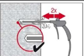
Bohrloch 2-mal vom Bohrlochgrund über die gesamte Länge mit ölfreier Druckluft (min. 6 bar bei  $6 \text{ m}^3/\text{h}$ ; falls notwendig mit Verlängerung) ausblasen, bis die rückströmende Luft staubfrei ist.
