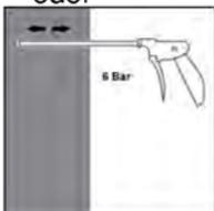
Injektionssystem Chemfix 500 für Bewehrungsanschlüsse
