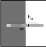
7. Bewehrungsstab mit leichter Drehbewegung (zur Verbesserung der Mörtelverteilung) bis zur Setztiefemarkierung in das Bohrloch einföhren
