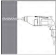
1. Bohrloch mit dem Durchmesser und der Bohrlochtiefe entsprechend des gewählten Bewehrungsseisens mit Hammerbohrer (HD) oder Druckluftbohrer (CD) in den Untergrund bohren.
