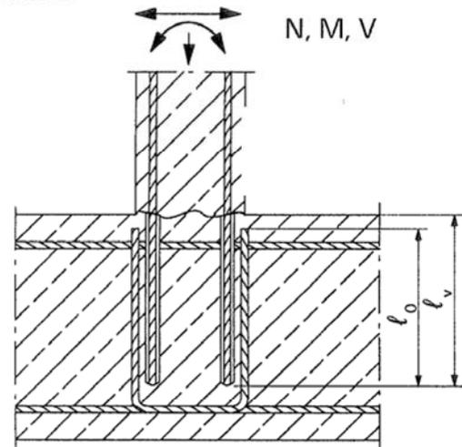
**Bild A3:** Endverankerung von Platten oder Balken
