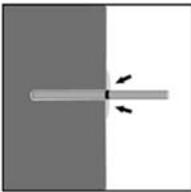
8. Nach Installation des Ankers sicherstellen, dass sich die Setztiefemarkierung an der Bohrlochoberfläche befindet und der Ringspalt komplett mit Mörtel ausgefüllt ist. Tritt keine Masse nach Erreichen der Setztiefe heraus, ist diese Voraussetzung nicht erfüllt und die Anwendung muss vor Beendigung der Verarbeitungszeit wiederholt werden. Bei Überkopfmontage ist der Bewehrungsstab zu fixieren (z.B. Holzkeile).
