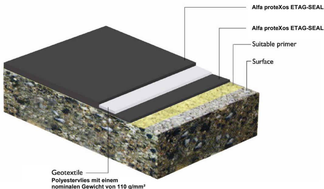
für die Dachabdichtung "Alfa proteXos ETAG-SEAL" gilt:
