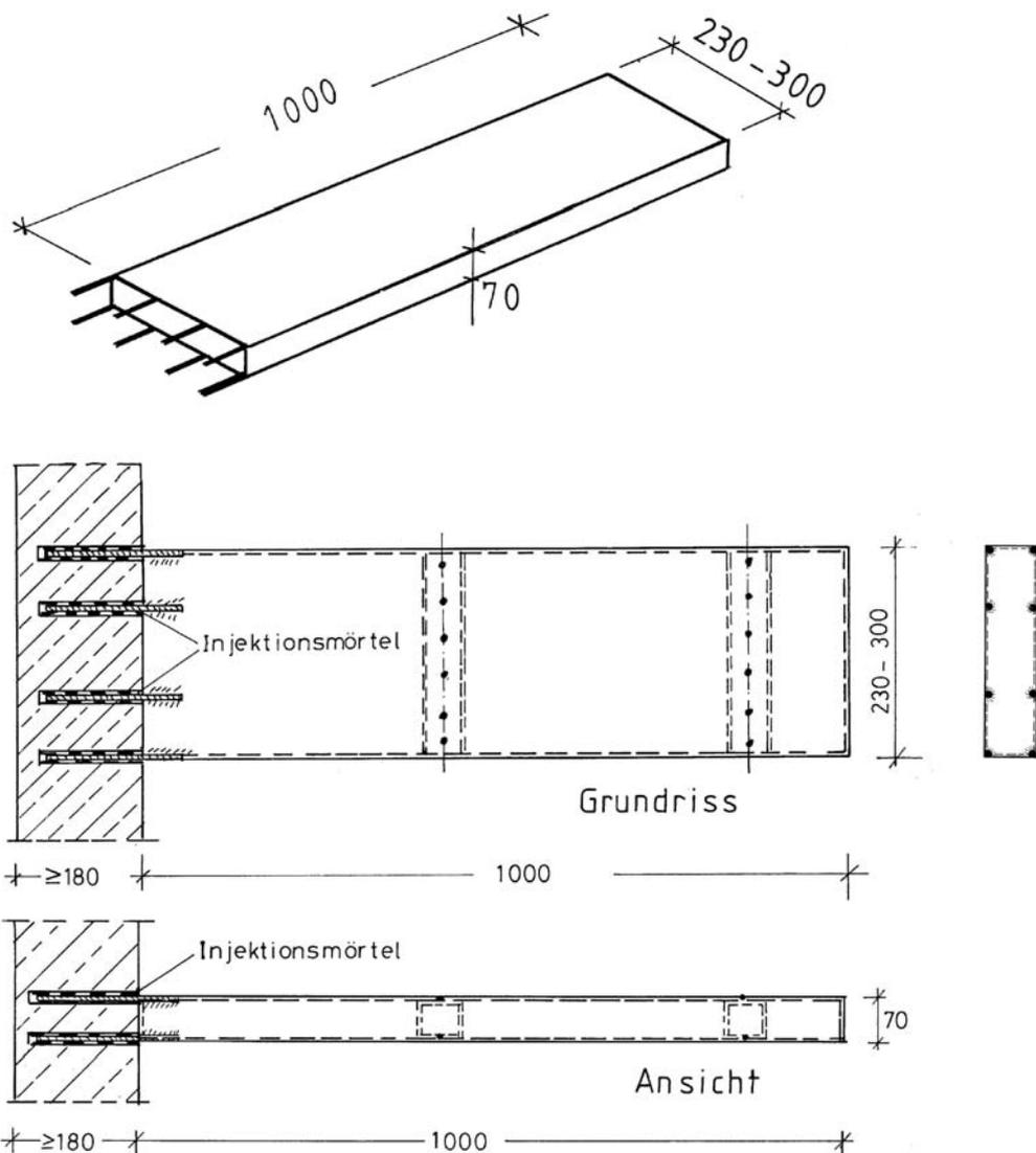
Maße in mm, weitere Details (Geometrie, Verbindungen usw.) entsprechend technischer Dokumentation
