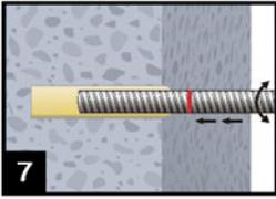
7. Bewehrungsstab mit leichter Drehbewegung (zur Verbesserung der Mörtelverteilung) bis zur Setztiefemarkierung in das Bohrloch einführen
