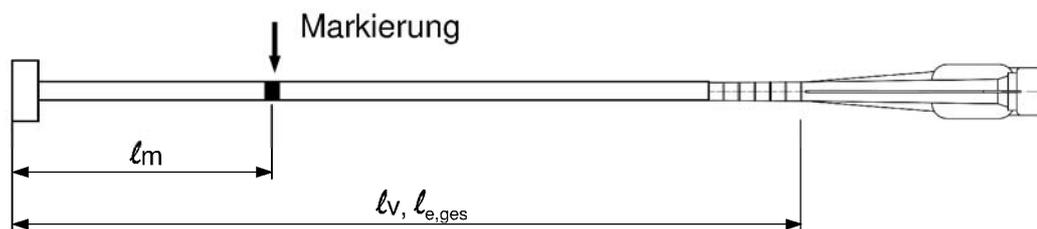
Auf Mischer und Mischerverlängerung müssen Mörtel-Füllmarke  $l_m$  und Verankerungstiefe  $l_v$  bzw.  $l_{e,ges}$  mit einem Klebeband oder Textmarker markiert werden. Grobe Abschätzung:  $l_m = 1/3 \cdot l_v$
