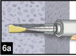
6. Gereinigtes Bohrloch vom Bohrlochgrund her ca. zu 2/3 mit Verbundmörtel befüllen. Langsames Zurückziehen des Statikmischers aus dem Bohrloch verhindert die Bildung von Luftpneischlüssen. Für Setztiefen größer 190 mm passende Mischerverlängerung verwenden.
