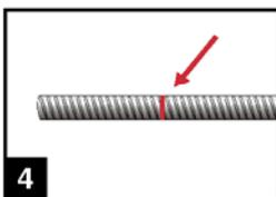
4. Vor dem Injizieren des Mörtels ist die Setztiefe auf dem Bewehrungsstab markieren (z.B. mit Klebeband). Danach den Bewehrungsstab in das leere Bohrloch einführen, um die korrekte Bohrlochtiefe  $l_v$  zu überprüfen. Die Ankerstange sollte schmutz-, fett-, und ölfrei sein.
