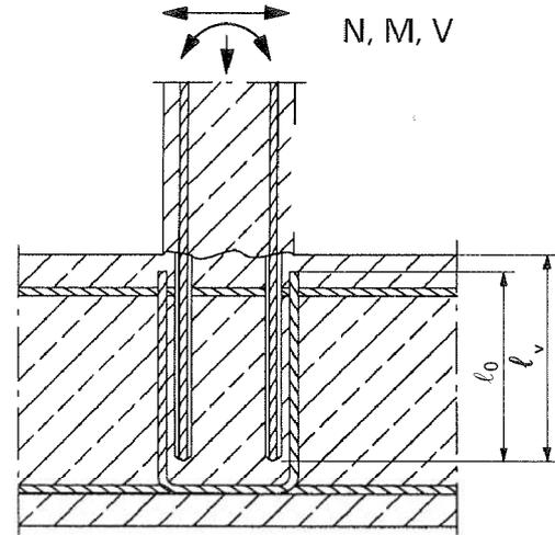
**Bild A3:** Endverankerung von Platten oder Balken
