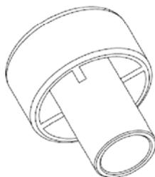
**Injektionsadapter für Überkopf- oder Horizontalmontage**
