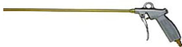
**Empfohlene Druckluftpistole (min 6 bar)**
