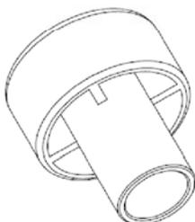
**Verfüllstutzen für Überkopf- oder Horizontalmontage**
