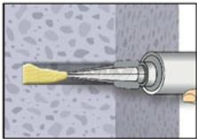
6. Gereinigtes Bohrloch vom Bohrlochgrund her ca. zu 2/3 mit Verbundmörtel befüllen. Langsames Zurückziehen des Statikmischers aus dem Bohrloch verhindert die Bildung von Lufteinschlüssen. Bei Verankerungstiefen größer 190 mm passende Mischerverlängerung verwenden. Für die Horizontal- oder Überkopfmontage sind Verfüllstutzen gemäß Anhang B 3 und Mischerverlängerungen zu verwenden. Die temperaturrelevanten Verarbeitungszeiten (Tabelle B 4) sind zu beachten.
