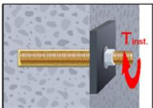
10. Nach vollständiger Aushärtung kann das Anbauteil mit dem zulässigen Drehmoment (Tabelle B2) montiert werden. Die Mutter muss mit einem geeignetem Drehmomentschlüssel festgezogen werden.
