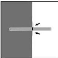
8. Nach Installation des Ankers sicherstellen, dass sich die Setztiefenmarkierung an der Bohrlochoberfläche befindet und der Ringspalt komplett mit Mörtel ausgefüllt ist. Tritt keine Masse nach Erreichen der Setztiefe heraus, ist diese Voraussetzung nicht erfüllt und die Anwendung muss vor Beendigung der Verarbeitungszeit wiederholt werden. Bei Überkopfmontage ist der Bewehrungsstab zu fixieren (z.B. Holzkeile).
