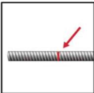
4. Vor dem Injizieren des Mörtels ist die Setztiefe auf dem Bewehrungsstab markieren (z.B. mit Klebeband). Danach den Bewehrungsstab in das leere Bohrloch einführen, um die korrekte Bohrlochtiefe  $l_v$  zu überprüfen.
