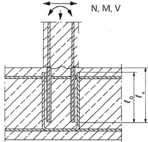
**Bild A3:** Endverankerung von Platten oder Balken
