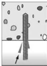
Bei Überkopfmontage das Verankerungselement mit Keilen fixieren.
