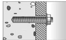
Bei Durchsteckmontage das Durchgangsloch im Anbauteil mit Mörtel verfüllen.
