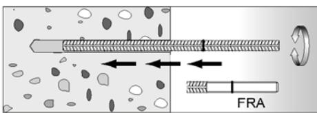
Nur sauberen und ölfreien Betonstahl verwenden. Betonstahl mit Setztiefenmarkierung versehen. Mit leichten Drehbewegungen den Bewehrungsstab oder den fischer Bewehrungsanker kräftig bis zur Setztiefenmarkierung in das gefüllte Bohrloch schieben. Beim Erreichen der Setztiefenmarkierung muss an der Betonoberfläche Überschussmörtel austreten.
