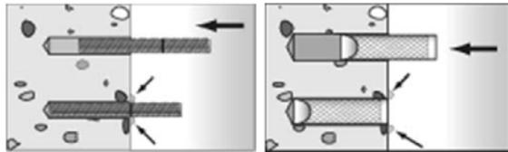
Nur saubere und ölfreie Verankerungselemente verwenden. Die Ankerstange oder den Innengewindeanker RG MI mit leichten Drehbewegungen in das Bohrloch schieben. Nach dem Setzen des Befestigungselementes muss Überschussmörtel aus dem Bohrlochmund austreten.
