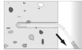
Bei Bohrlochtiefen  $\geq 150$  mm Verlängerungsschlauch verwenden.
