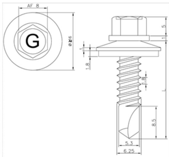
**Verbindungselement:** Bimetall – Bohrschraube
