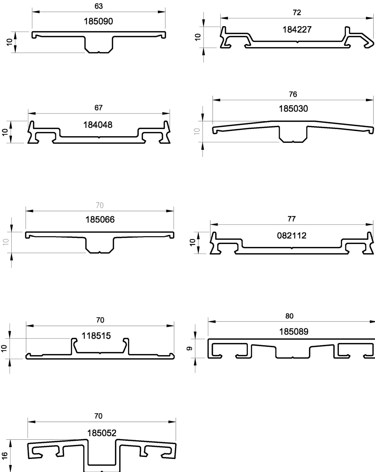
Befestigungssystem für das Fassadensystem THERM+ S-I
