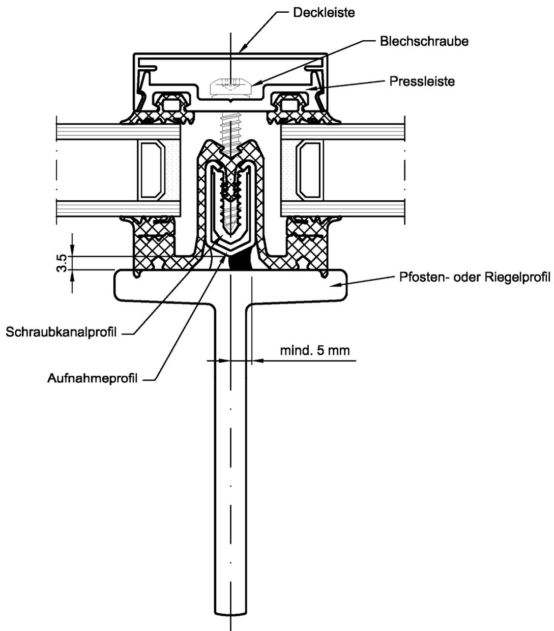
Befestigungssystem für das Fassadensystem THERM+ S-I
