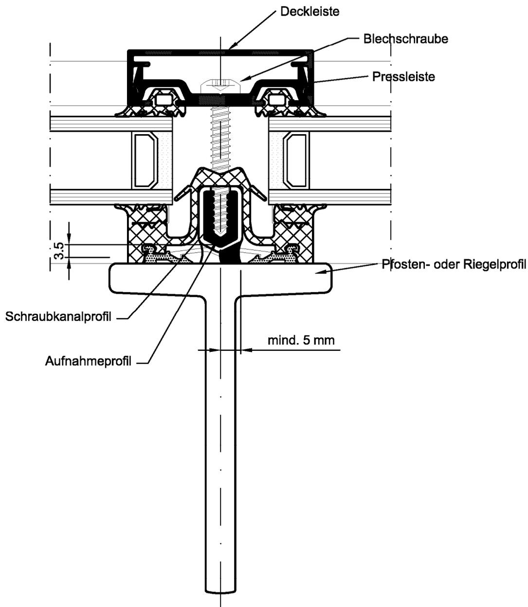
Befestigungssystem für das Fassadensystem THERM+ S-I
