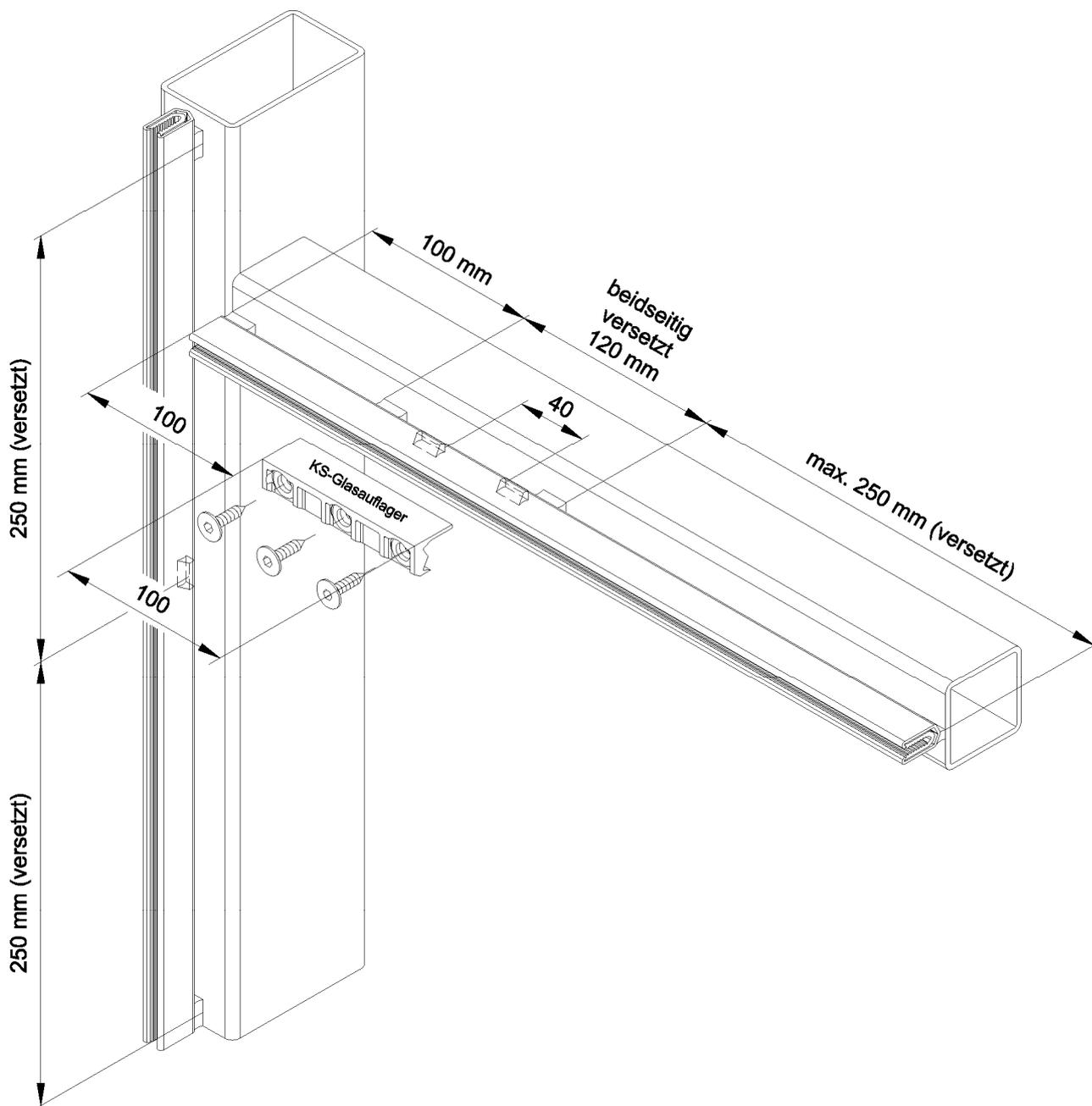
Befestigungssystem für das Fassadensystem THERM+ S-I
