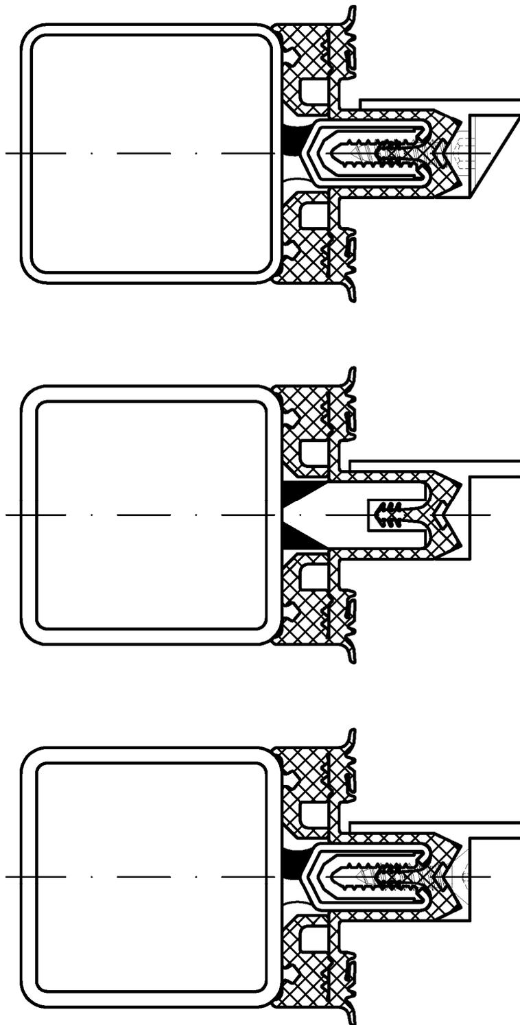
Befestigungssystem für das Fassadensystem THERM+ S-I
