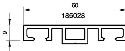
Befestigungssystem für das Fassadensystem THERM+ S-I
