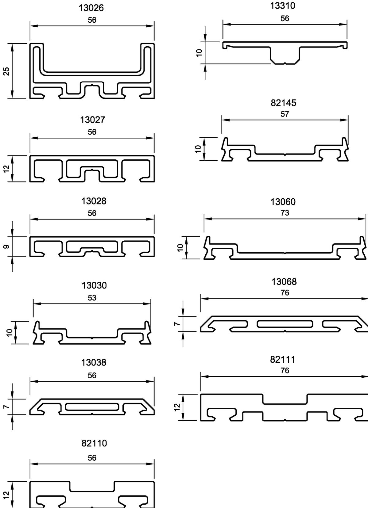
Befestigungssystem für das Fassadensystem THERM+ S-I
