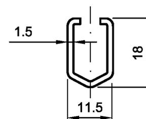
Befestigungssystem für das Fassadensystem THERM+ S-I
