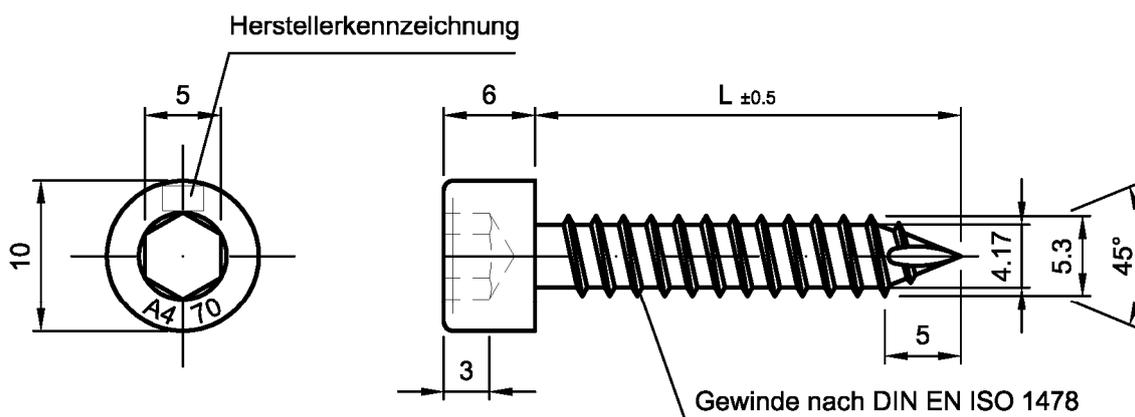
Befestigungssystem für das Fassadensystem THERM+ S-I
