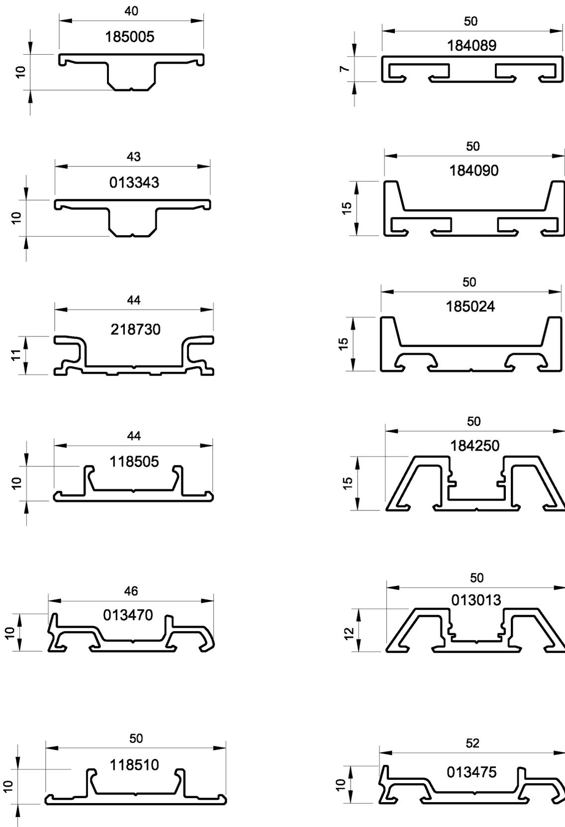
Befestigungssystem für das Fassadensystem THERM+ S-I
