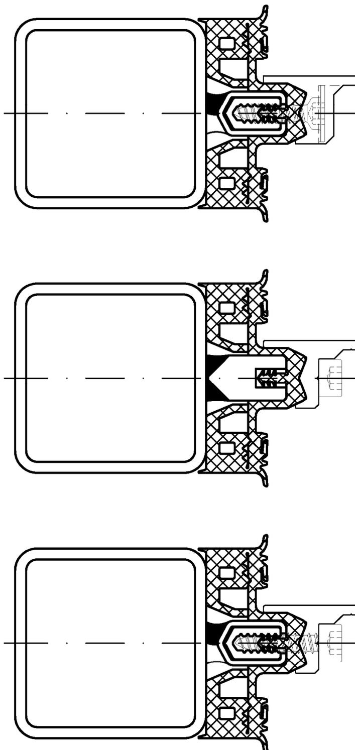
Befestigungssystem für das Fassadensystem THERM+ S-I
