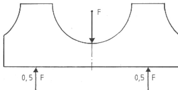
Bild 1: Belastungsanordnung Biegeversuch
