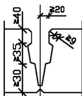
Verwendung von Spannbeton-Hohlblatten nach DIN EN 1168:2011-12 und
