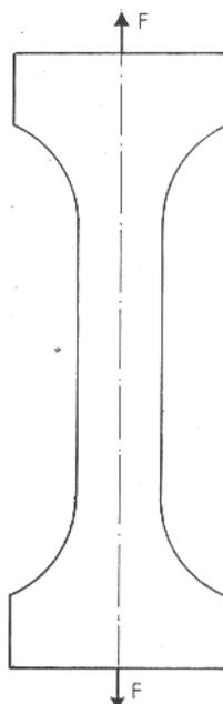
Bild 2: Belastungsanordnung Zugversuch
