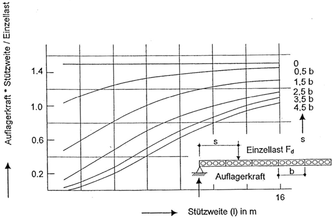
Auflagerkraft am Längsrand infolge Einzellast in Feldmitte
