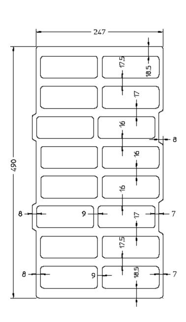
Mauerwerk aus THERMOPOR-Planhochlochziegeln mit integrierter Wärmedämmung (bezeichnet als "THERMOPOR TV 7 - Plan" und "THERMOPOR TV 8 - Plan")
