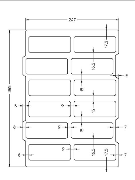
Mauerwerk aus THERMOPOR-Planhochlochziegeln mit integrierter Wärmedämmung (bezeichnet als "THERMOPOR TV 7 - Plan" und "THERMOPOR TV 8 - Plan")
