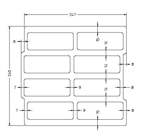
Mauerwerk aus THERMOPOR-Planhochlochziegeln mit integrierter Wärmedämmung (bezeichnet als "THERMOPOR TV 7 - Plan" und "THERMOPOR TV 8 - Plan")
