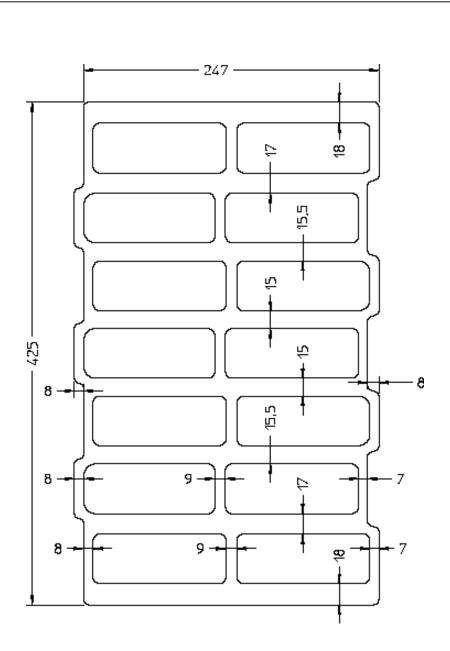
Mauerwerk aus THERMOPOR-Planhochlochziegeln mit integrierter Wärmedämmung (bezeichnet als "THERMOPOR TV 7 - Plan" und "THERMOPOR TV 8 - Plan")
