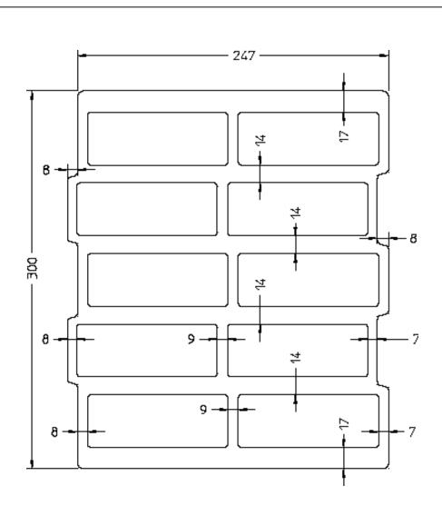
Mauerwerk aus THERMOPOR-Planhochlochziegeln mit integrierter Wärmedämmung (bezeichnet als "THERMOPOR TV 7 - Plan" und "THERMOPOR TV 8 - Plan")
