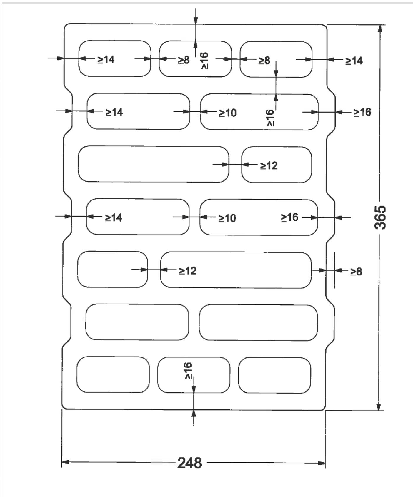
Mauerwerk aus POROTON Planhochlochziegeln mit integrierter Wärmedämmung
