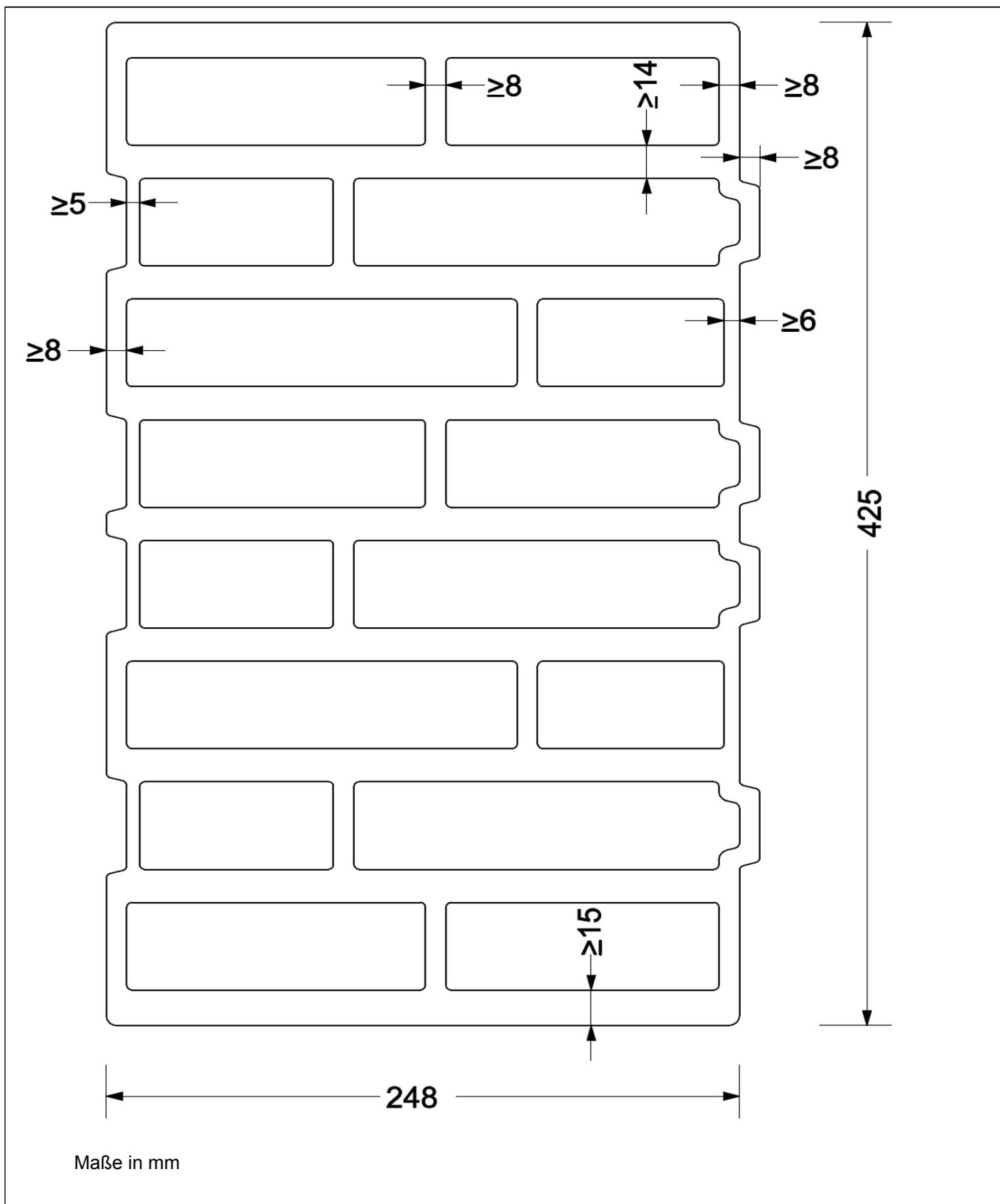
Mauerwerk aus POROTON Planhochlochziegeln mit integrierter Wärmedämmung
