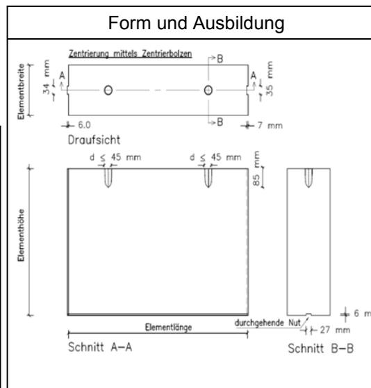
Alternative Werte der deklarierten Länge (l), Breite (t) und Höhe (h) in mm
