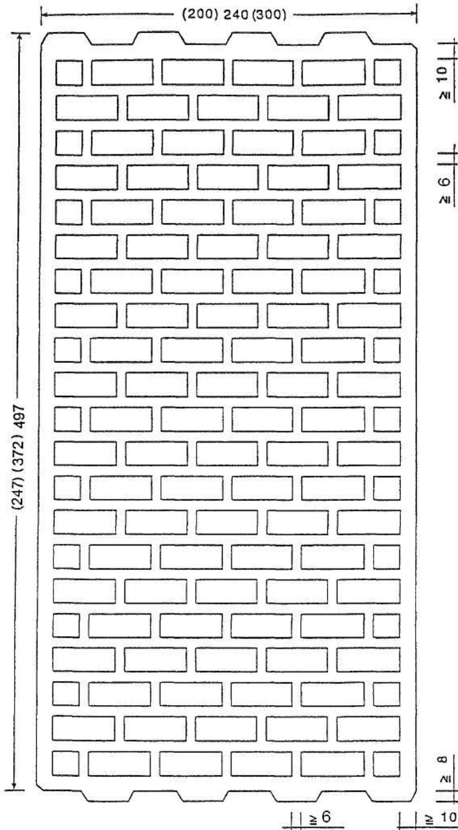
Mauerwerk aus THERMOPOR-Planhochlochziegeln
