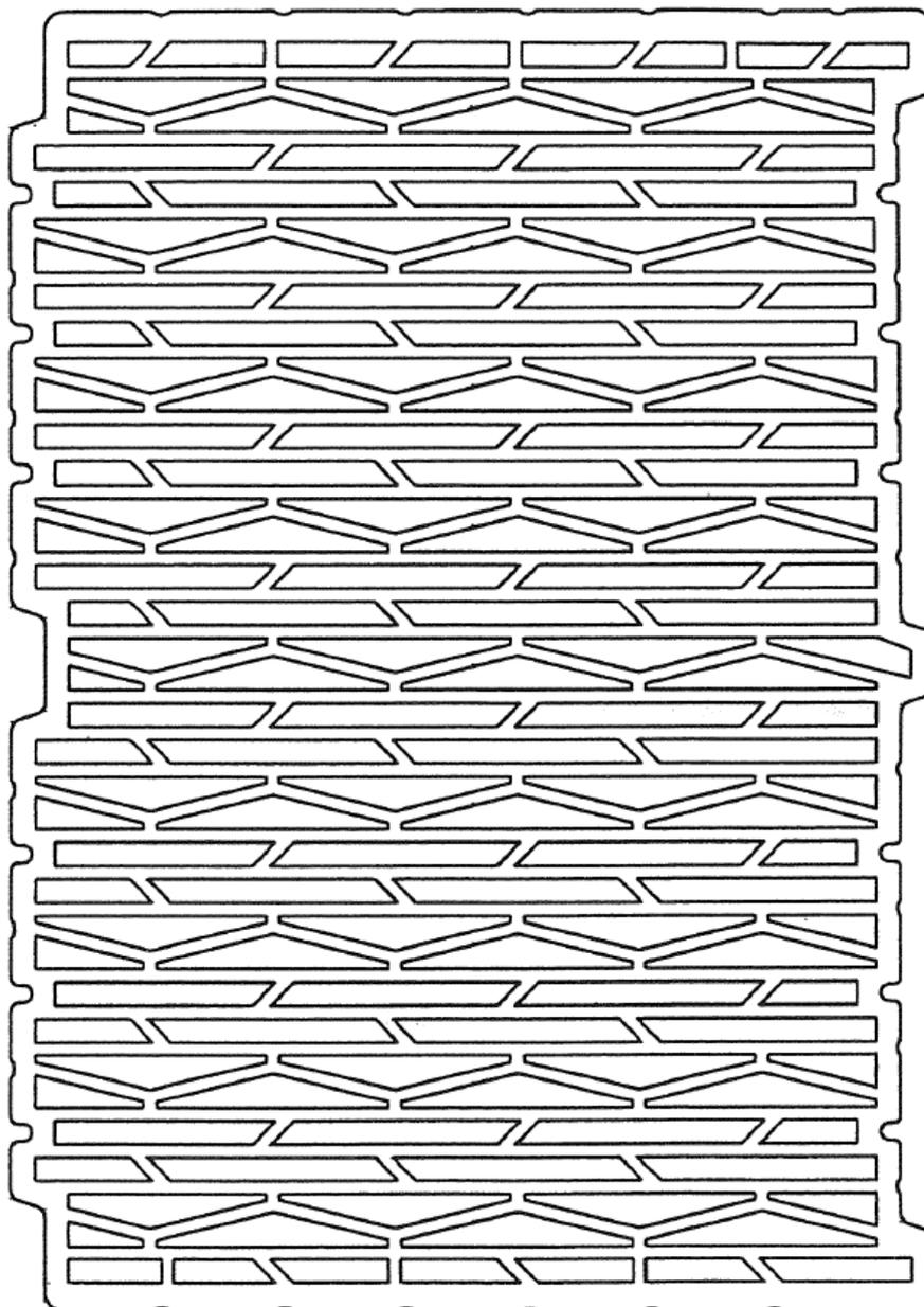
Mauerwerk aus THERMOPOR SL Planziegeln im Dünnbettverfahren mit gedeckelter Lagerfuge (bezeichnet als "THERMOPOR SL Plan")
