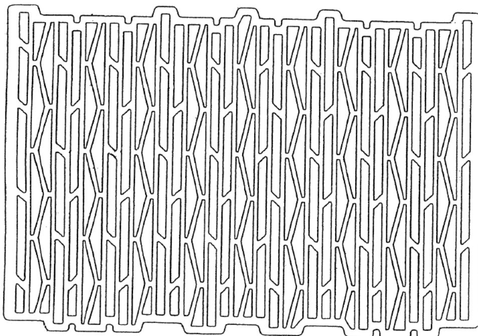
Mauerwerk aus THERMOPOR SL Planziegeln im Dünnbettverfahren mit gedeckelter Lagerfuge (bezeichnet als "THERMOPOR SL Plan")
