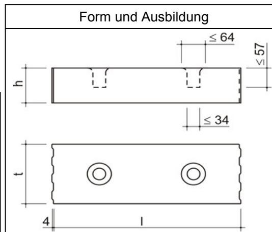
Alternative deklarierte Breite (t) und Höhe (h) in mm
