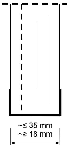
Brandschutz-Verbund-Sicherheitsglas gemäß DIN EN 14449 bestehend aus Floatglasscheiben, mit zwischen liegenden Funktionsschichten und PVB-Folie.
