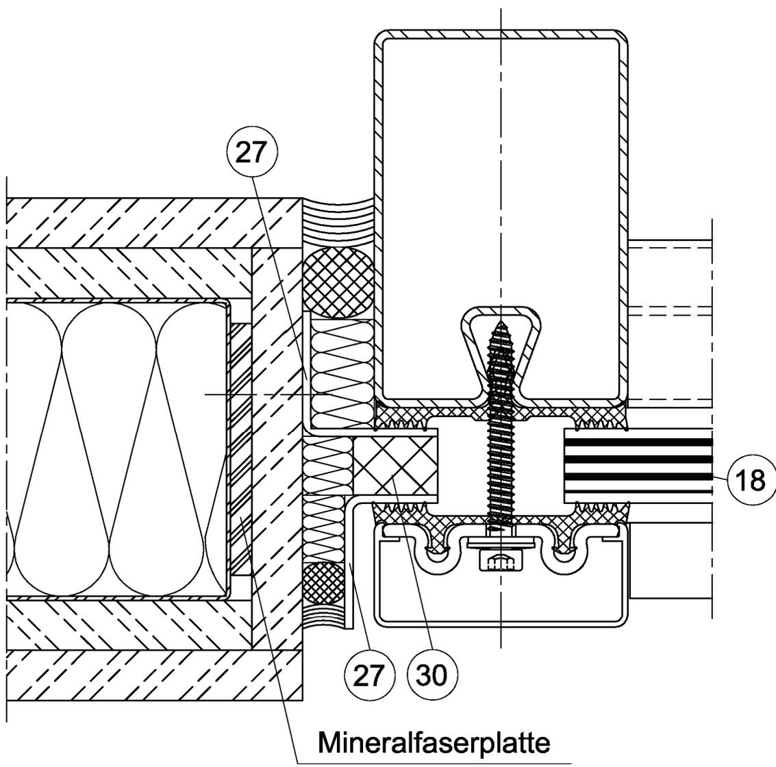
seitlicher Anschluss an Trennwand nach DIN 4102 - 4, Tab. 48
