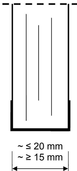
Brandschutz-Verbund-Sicherheitsglas gemäß DIN EN 14449 bestehend aus Floatglasscheiben mit zwischen liegenden Funktionsschichten.
