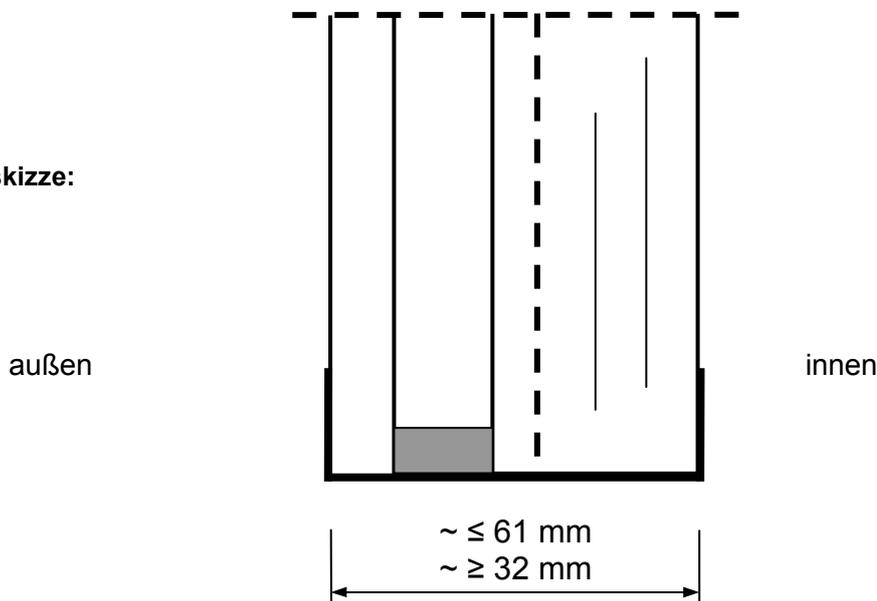
Brandschutzisoliertes Glas gemäß DIN EN 1279-5 bestehend aus Verbund-Sicherheitsglas gemäß DIN EN 14449 aus Floatglasscheiben mit zwischen liegenden Funktionsschichten und PVB-Folie sowie vorgesetzter Außenscheibe.
