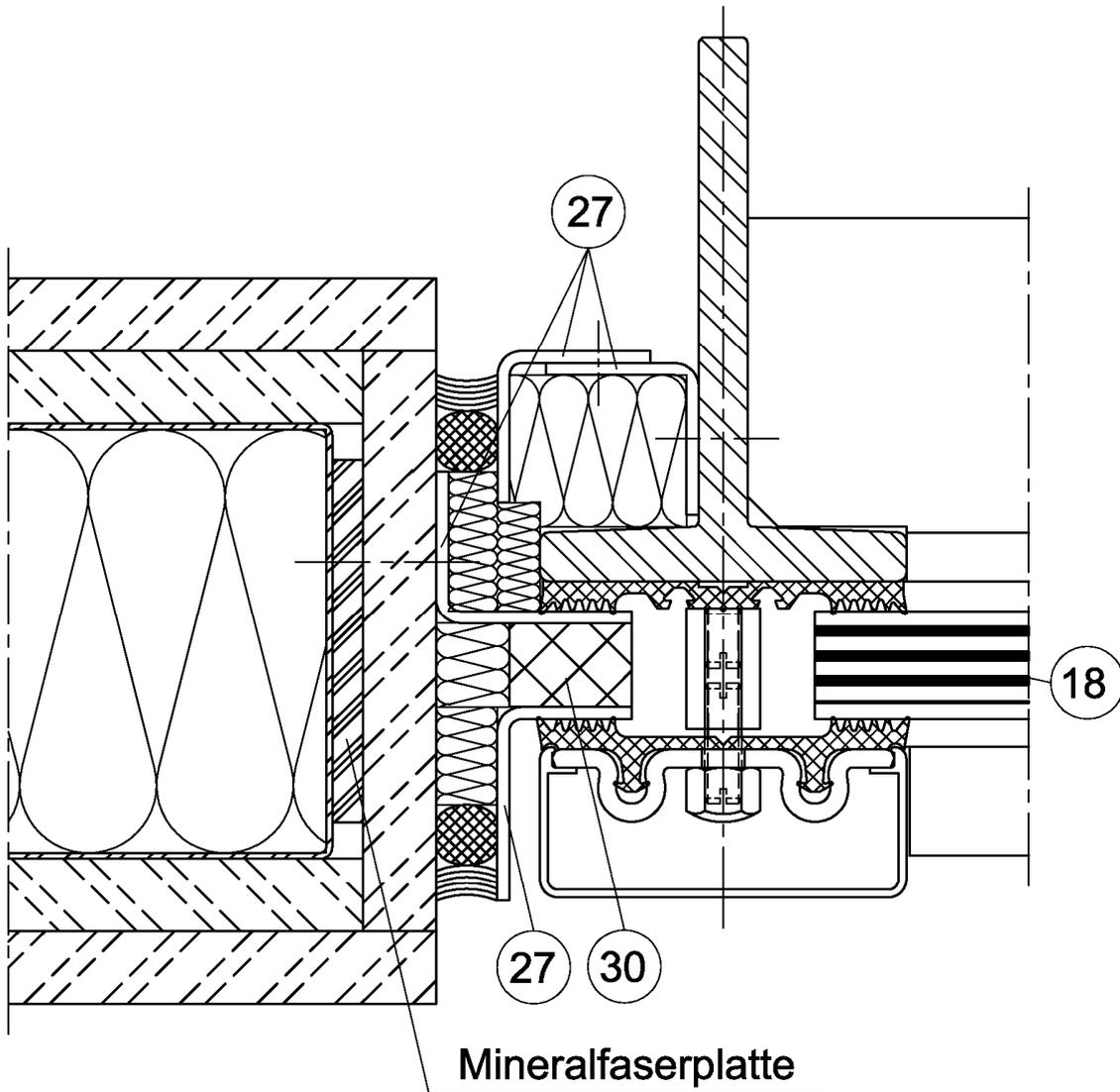
seitlicher Anschluss an Trennwand nach DIN 4102 - 4, Tab. 48
