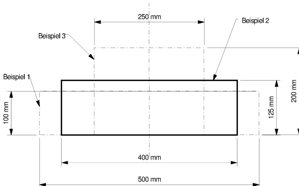
Die maximale Öffnungsgröße beträgt 500 cm<sup>2</sup>. Dabei ist zu beachten, dass die maximale Breite von 50 cm und die maximale Höhe von 20 cm nicht überschritten wird. Das Produkt aus Breite mal Höhe darf dabei die 500 cm<sup>2</sup> nicht überschreiten.
