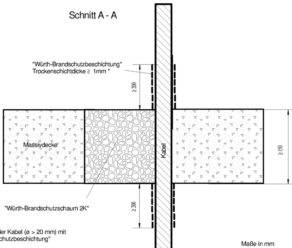
\*) Beschichtung der Kabel ( $\text{Ø} > 20 \text{ mm}$ ) mit
