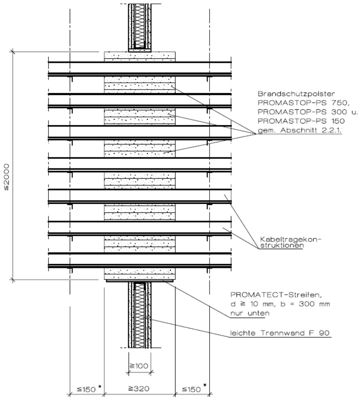
\* bei Kabelabschottungen die breiter als 700 mm oder höher als 400 mm sind, müssen die Kabelpstrichen beiderseits  $\leq 150$  mm vor der Abschottungsoberfläche unterstützt werden. Bei kleineren Abschottungen sind 500 mm ausreichend.
