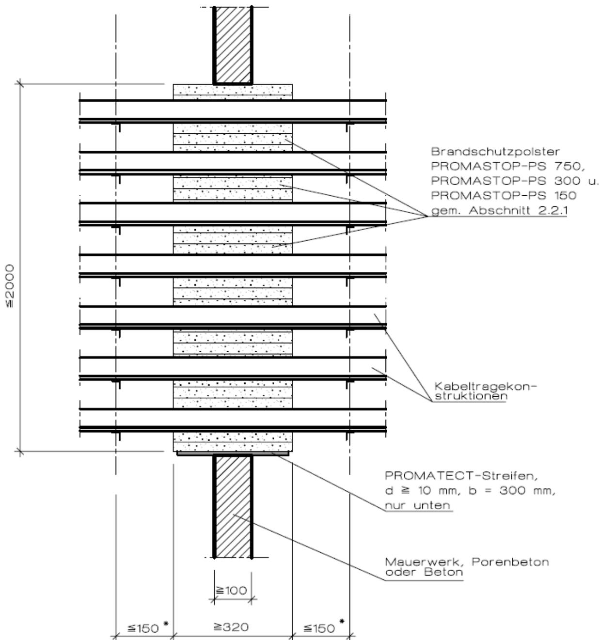
\* bei Kabelabschottungen die breiter als 700 mm oder höher als 400 mm sind, müssen die Kabeltragschienen beiderseits  $\leq 150$  mm vor der Abschottungsoberfläche unterstützt werden. Bei kleineren Abschottungen sind 500 mm ausreichend.
