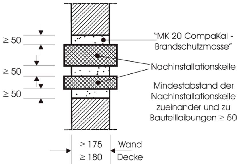
Abmessungen der Nachinstallationskeile
