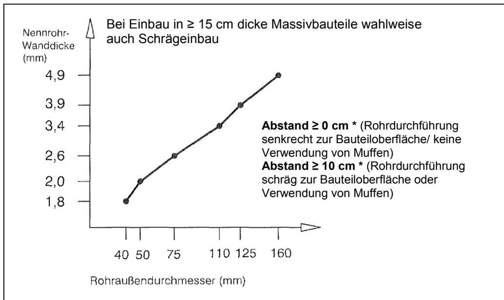
**Rohre gemäß Rohrgruppe F:** (Rohrmanschette "UNIFOX" oder "UNIFOX plus", wahlweise Verwendung von Muffen bei Deckeneinbau an senkrechten Rohren, keine Isolierung)
