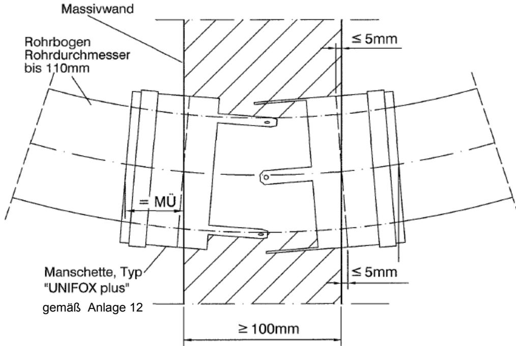
Kabeldurchführung bei Rohrpostanlagen
