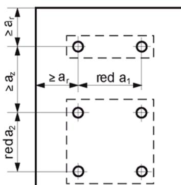
Reduzierte zulässige Lasten bei reduzierten Achsabständen je Dübel bei Dübelgruppen  $min a \leq red a \leq a$  (siehe Abschnitt 3.2.3.1)
