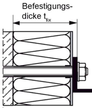
Befestigungsschraube/ Gewindestange/ Mutter und Scheibe müssen immer dem Werkstoff der Innengewindehülse entsprechen. Siehe Anlage 5, Tabelle 4.
