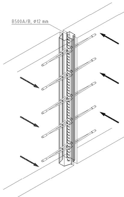
Bild 19: Beanspruchung senkrecht zur Fugenlängsrichtung und Wandebene
