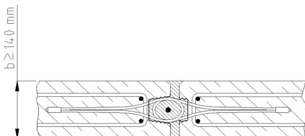
Bild 5: Wand - Wandverbindung
