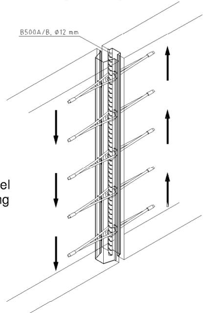
Bild 18: Beanspruchung parallel zur Fugenlängsrichtung
