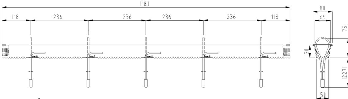
Bild 1: VS<sup>®</sup>-ISI-50 (Längs- und Querschnitt)
