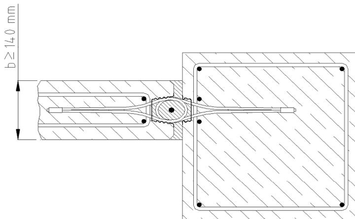
Bild 6: Stützen - Wandverbindung
