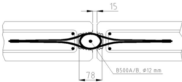
Bild 13: Minimale Fugenbreite
