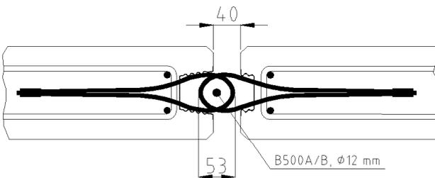
Bild 14: Maximale Fugenbreite
