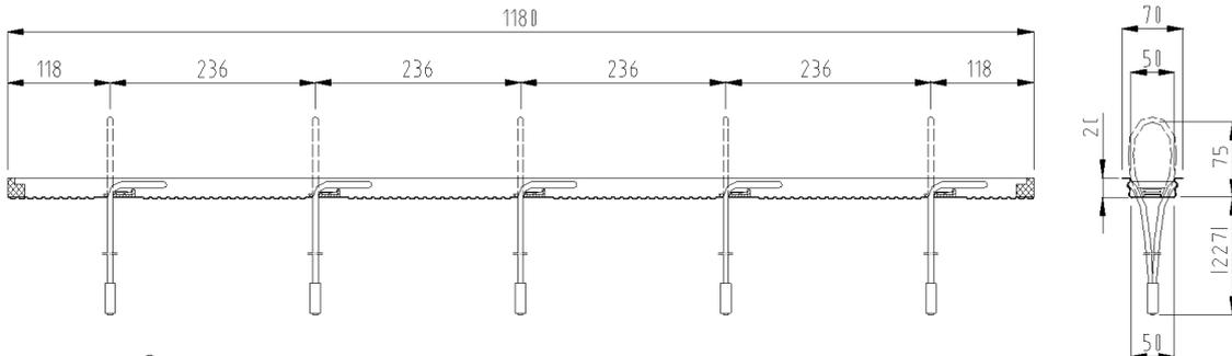
Bild 3: VS<sup>®</sup>-ISI-20 (Längs- und Querschnitt)
