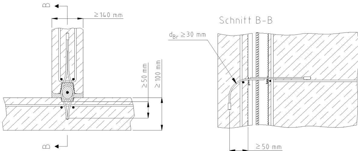
Bild 10: Wand - Wand – T-Verbindung - Detail bei abgewinkelter Seilschlaufe
